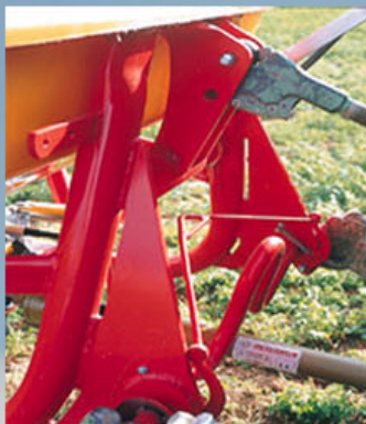
Enganche rapido diseñado en M para liberar la barra de enganche.
