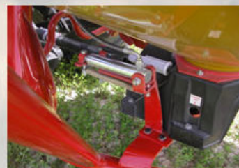
Sistema de apertura hidraulico.
