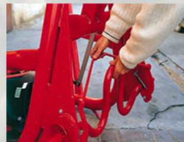
Comodo dispositivo con palanca para liberar la barra de enganche
